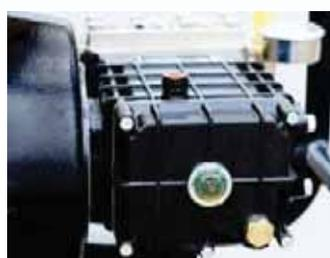
*Маслонаполненный картер с системой смазки коленвала*
