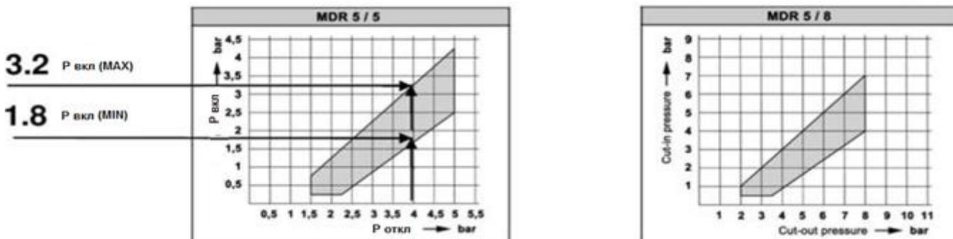
Пример: при установленном давлении отключения (P откл.) - 4 бара, давление включения может быть отрегулировано в диапазоне от 3,2 до 1, 8
