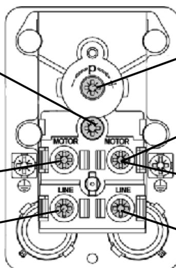
Регулировка давления включения
