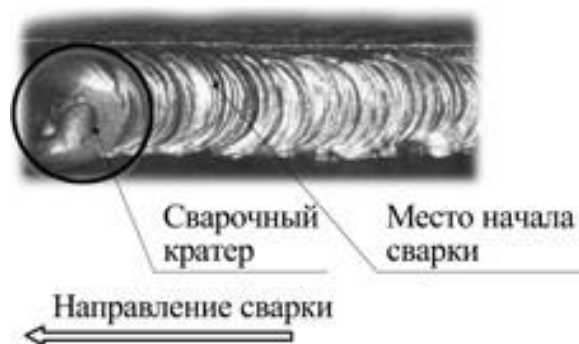
Рис. 8.3. Начало сварки при смене электрода.
