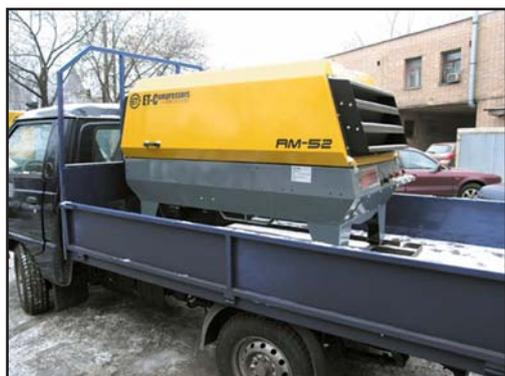
Компрессор в стационарном исполнении удобен для монтажа в кузове грузового автомобиля и не занимает много места, оставляя пространство для шлангов и инструмента.
