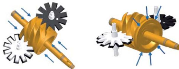
Осевые нагрузки действуют с обеих сторон главного винта
