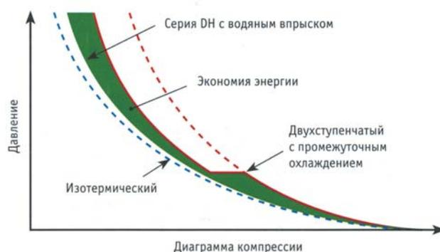
Водяной впрыск означает более низкие температуры, а это, в свою очередь, означает более эффективную компрессию.
