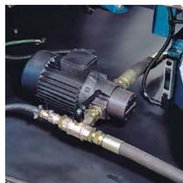
Масляный насос с электрическим приводом обеспечивает оптимальную смазку всех механизмов, увеличивая срок их эксплуатации.
