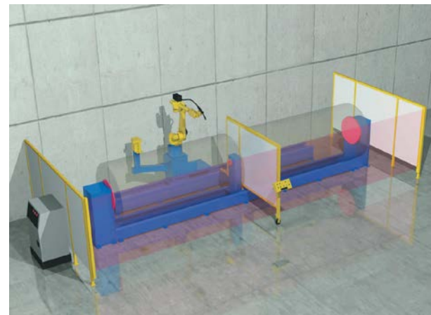
▲ Робот, установленный на платформе, перемещающейся между двумя «горизонтальными» позиционерами (9 осей)
