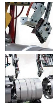
▶ Установка для MIG/MAG сварки деталей пищевых емкостей автоматической центровкой свариваемых деталей.
