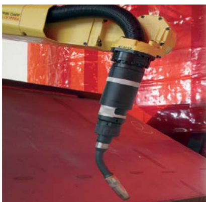
▲ ► Применение роботизированного комплекса для сварки балок.
