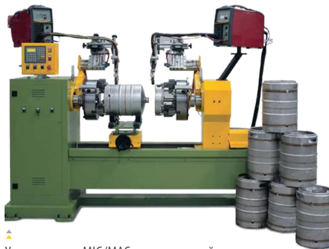
▶ Установка для MIG/MAG сварки деталей пищевых емкостей автоматической центровкой свариваемых деталей.
