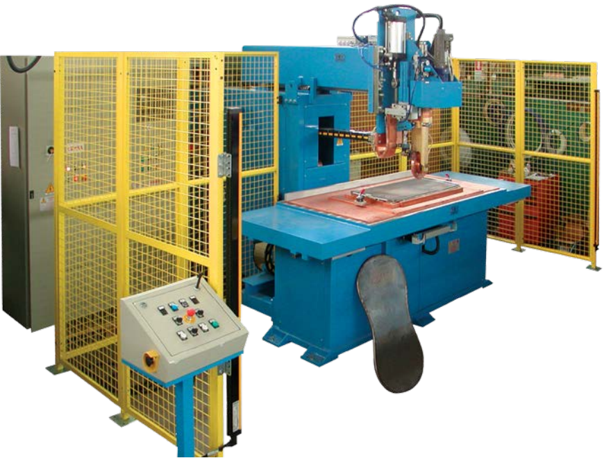
◀ ▶ Автоматическая установка для сварки моек.
